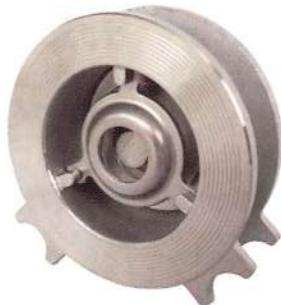
チャッキバルブは、流体の流れを常に一定方向に保ち、逆流を防止する機能を持つバルブです。ジスクは、流体圧によって押し開かれる状態になりますが、逆流するとジスクが背圧によってボデーのシートに密着して、逆流を防止するものです。
