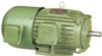
インバータ専用モーターはインバーター駆動専用にモーターのコイルの絶縁が強化されたモーターであり、その中でもインバータ専用定トルクモーターはその名のとおり、一般的に6~60Hzの範囲で定格トルクで連続運転可能なモーターです。
