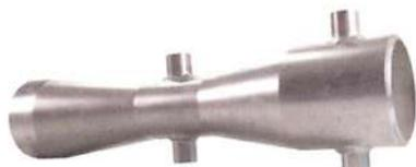
ベンチュリは、流体の流れを絞ることによって、流速を増加させて、低速部にくらべて低い圧力を発生させる機構である。
