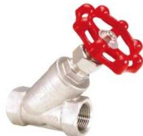
グローブバルブとは、バルブの中でも外観が球状 (Globe) になっている部品です。開閉時間が短く、ジスク形状があるため、流動特性を変更できる特徴があります。また、使用温度や圧力の範囲が広く、中間開度の使用に適しているのも、グローブバルブの特徴です。
