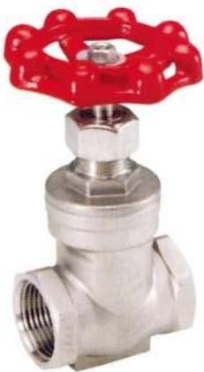
ゲートバルブはゲート弁ともいい、板状の弁体を使って流路を開閉し流体をコントロールします。
