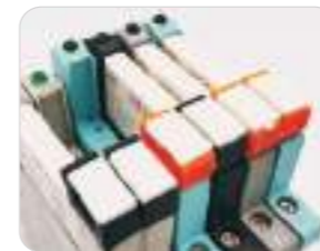
标记每一个继电器所连接的线路
