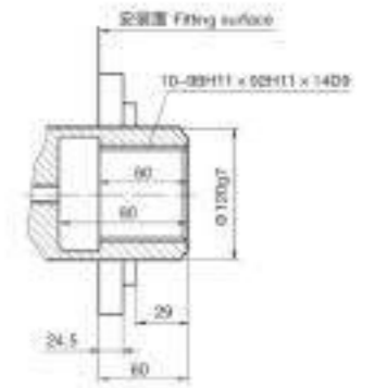
标准内花键 : ZM16-**I Standard Female Spline
