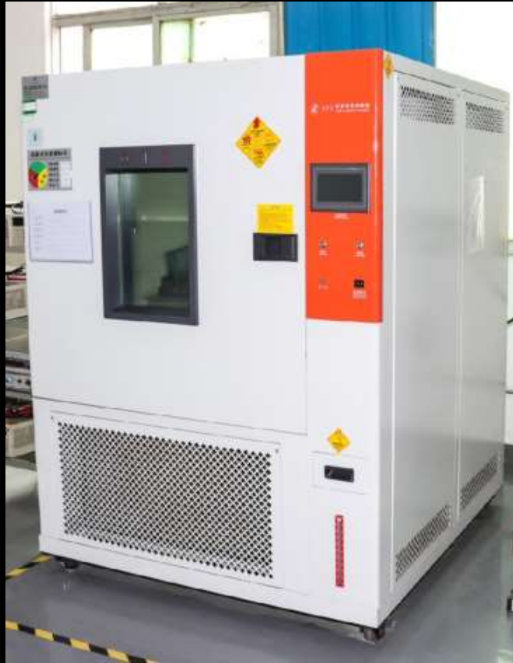
Temp. & humidity controlled 温度と湿度制御設備
