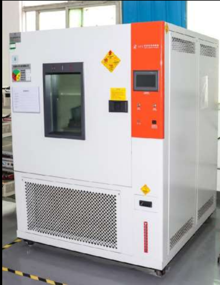
Temp. & humidity controlled 温度と湿度制御設備
